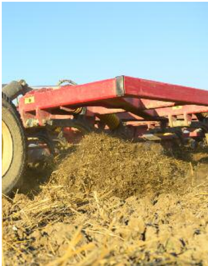
Hastigheten vid nedbrukningen är mellan 8 och 13 km/h. Peter är mån om så hög hastighet som möjligt för ökat jordflöde i maskinen. Med hög hastighet exploderar jorden i luften när 50-mm spets och 80-mm ledskena samarbetar.
