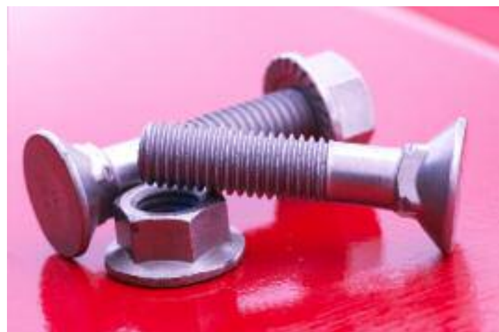
De nya kragmuttrarna med integrerad bricka på muttern testade Peter under 2014. De låser sig själva och Peter slapp efterdra muttrarna. Det gör att spetsarna inte kan vrida sig och bli skeva på pinnen. Bult och kragmuttrar tillverkas i härdat stål, 12:9 kvalitet.
