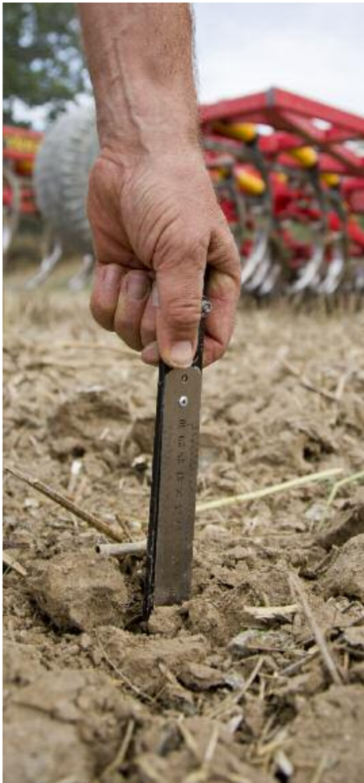
Bearbetningsdjupet är centralt för ett bra jobb menar Peter som mäter djupet med en egentillverkad mätare – en linjal på ett plattjärn som går att sticka ner i jorden.
