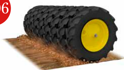
I sitt examensarbete från 2007 på SLU i Alnarp visar Carl Andersson och Christian Gustavsson på fördelarna med OffSet-monterade hjul jämfört med så kallade rakhjuliga, när det kommer till lättare jordar. Tack vare bättre genomsläpplighet blir såväl jordmotståndet som vibrationerna 25 % lägre.
