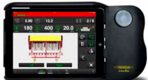
E-Control består av en iPad Air-enhet som via WiFi kommunicerar trådlöst med Gateway. För Väderstad har den elektroniska eran bara startat.
