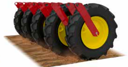
I sitt examensarbete från 2007 på SLU i Alnarp visar Carl Andersson och Christian Gustavsson på fördelarna med OffSet-monterade hjul jämfört med så kallade rakhjuliga, när det kommer till lättare jordar. Tack vare bättre genomsläpplighet blir såväl jordmotståndet som vibrationerna 25 % lägre.
