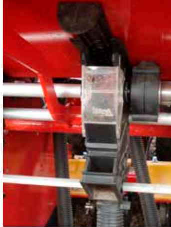
Spårmarkering gödning blir standard. Förhindrar gödning av ogräs i sprutspår.
