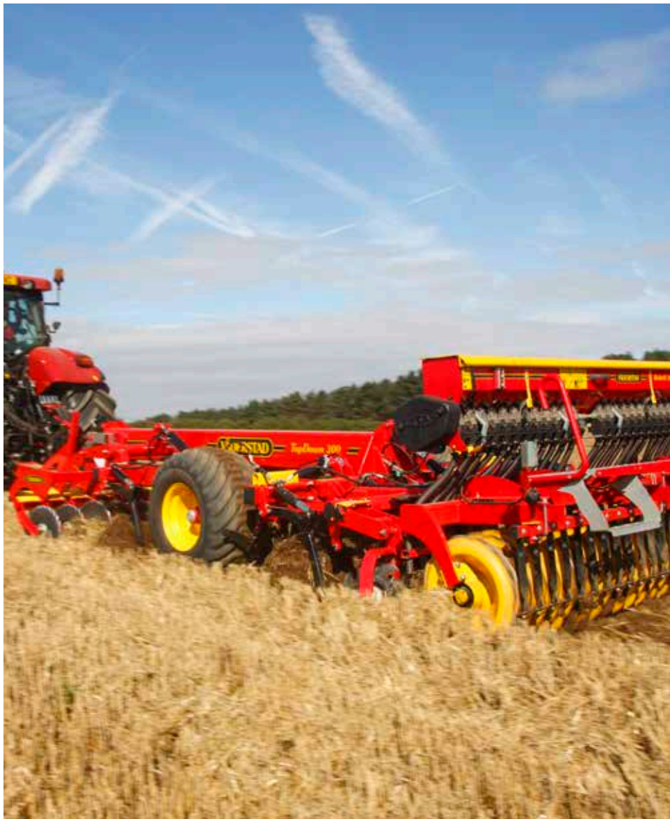
Med tallrikar, pinnar och återpackande vält finns exempel från praktiken på att TopDown kan vara ett effektivt vapen mot sniglar.
