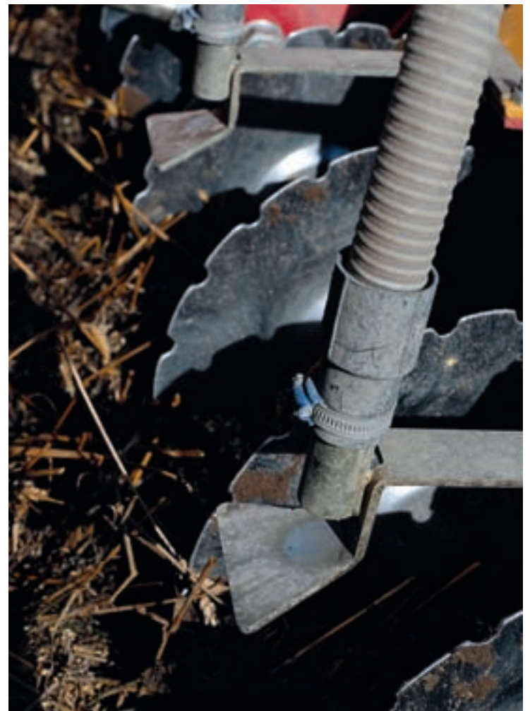
Розподільчі форсунки рівномірно розташовані по всій робочій ширині >
