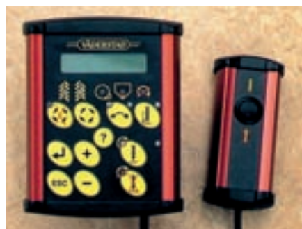
◀ Пульт управління сівалки в кабіні трактора показує засіяну площу, оберти вентилятора, норму висіву та оберти висівної котушки
