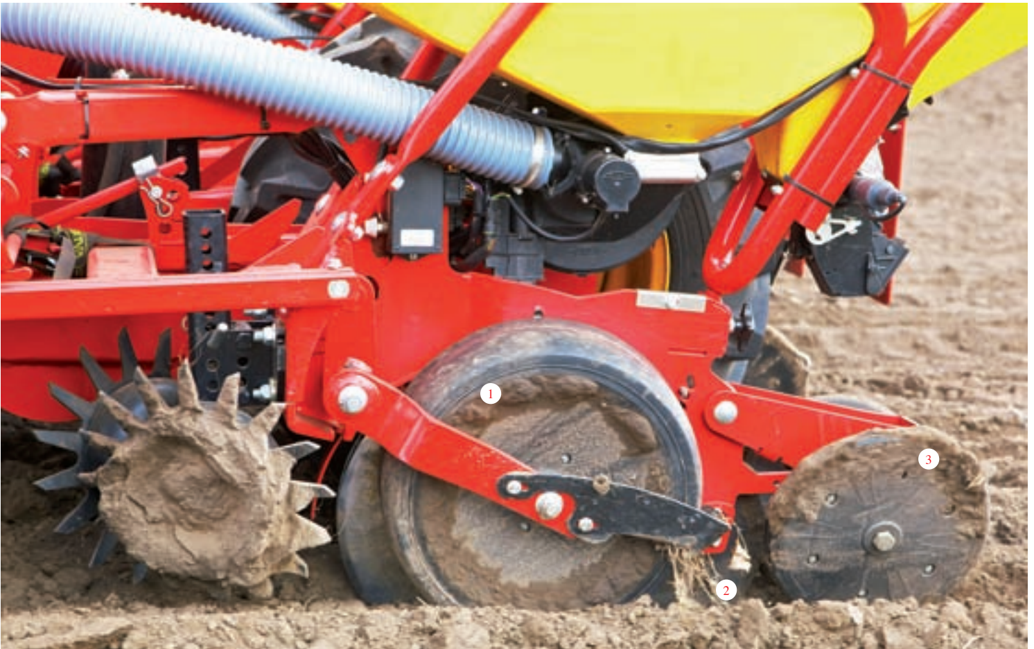
Нижня частина висівної секції сівалки Tempo Väderstad
